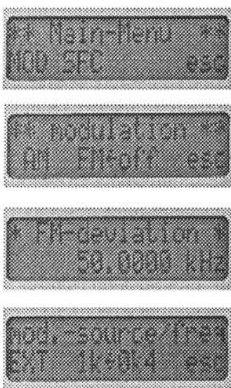
Innerhalb der Menüs ermöglicht die Taste **ESC** jederzeit den Abbruch der Auswahl. Alle Einstellungen werden gespeichert und bleiben auch nach dem Ausschalten des HM 8133 erhalten.
